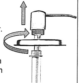
**Halten Sie das äußere Förderrohr mit dem Gewinde nach oben, damit die innenliegende Feder nicht hinausfällt.**
