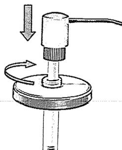
**Bitte beachten Sie beim Hineinschieben des inneren Förderrohres, dass die zwei O-Ringe (Dichtungsringe) am unteren Ende des inneren Rohres nicht verschoben werden.**
